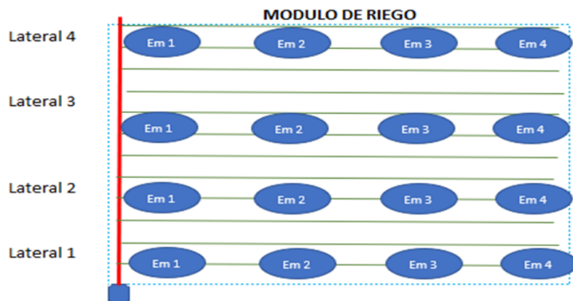
Fig 1. Esquema de módulo montado para evaluación de aspersores.
