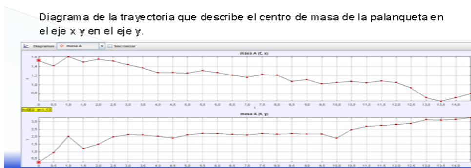
Fig 5. Diagrama de la trayectoria que describe el centro de masa de la palanqueta en los ejes X y Y.
