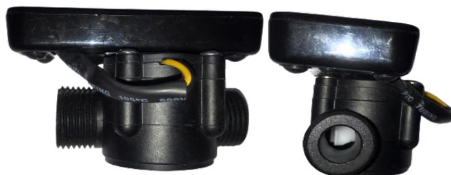
Figura 5. Prototipo del dispositivo para medición del consumo del agua potable. Fuente: Elaboración propia.
