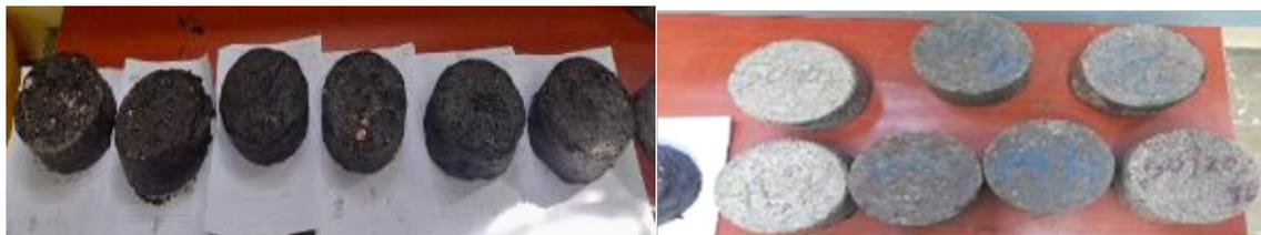
Imagem 2: Espécimes de corte úmidos e secos com suas diferentes proporções de materiais.
