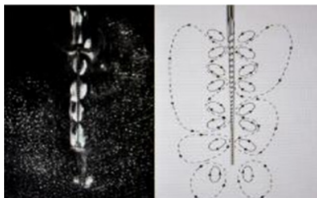
Figura 2. Activación ultrasónica Efecto de la activación ultrasónica sobre un líquido. Nodos y antinodos que aparece como consecuencia de la energía ultrasónica. Fuente: (Rodríguez et al., 2015).
