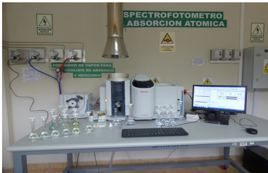
Figura 4. Análisis de las muestras de agua y trucha arco iris procedentes de las cuencas hidrográficas Sicra, Opamayo y piscigranja de Ocopa, en el espectrofotómetro de absorción atómica para determinar las concentraciones de arsénico, cadmio y plomo.
