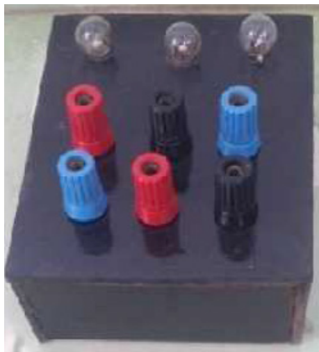
Figura 10. Carga utilizada con el generador sincrónico trifásico.
