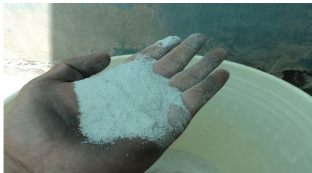
Figura 9. Obtención de polvo de vidrio reciclado.
