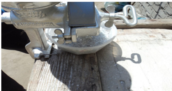
Figura 7. Trituración de vidrio reciclado.
