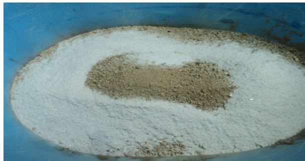
Figura 8. Molienda de vidrio reciclado.
