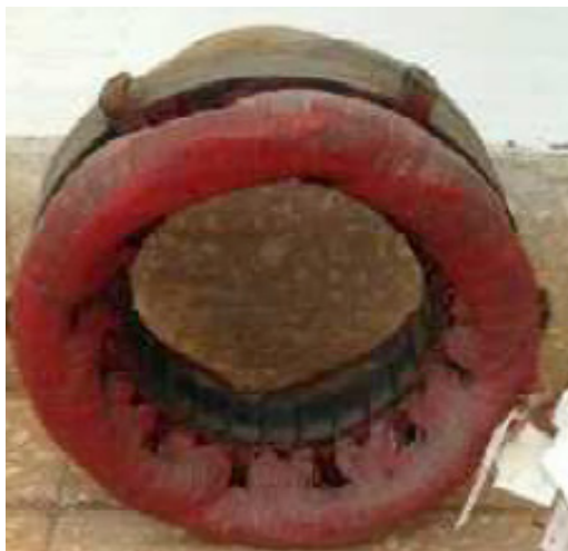
Figura 7. Estator del generador sincrónico trifásico.
