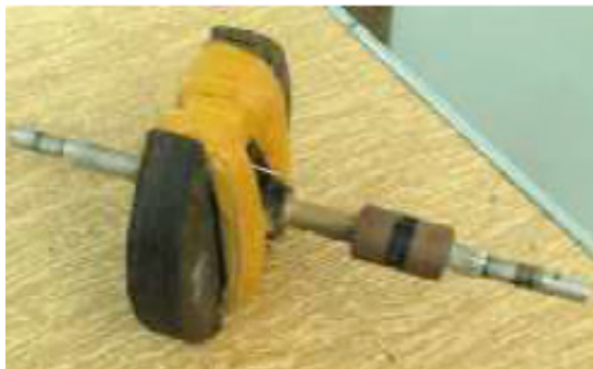
Figura 6. Rotor del generador sincrónico trifásico.
