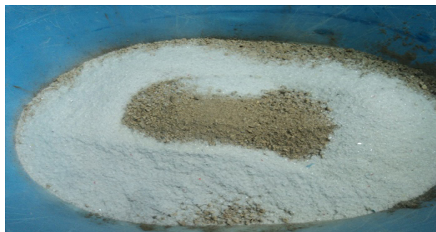
Figura 8. Molienda de vidrio reciclado.
