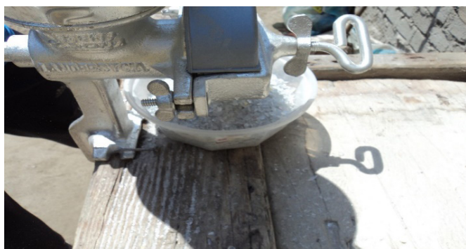
Figura 7. Trituración de vidrio reciclado.
