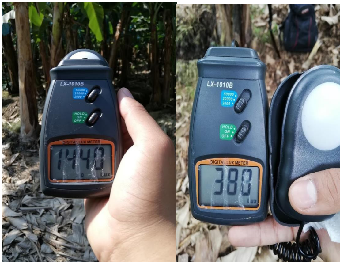
Figura 2. Toma de lux con la ayuda de un luxómetro.
