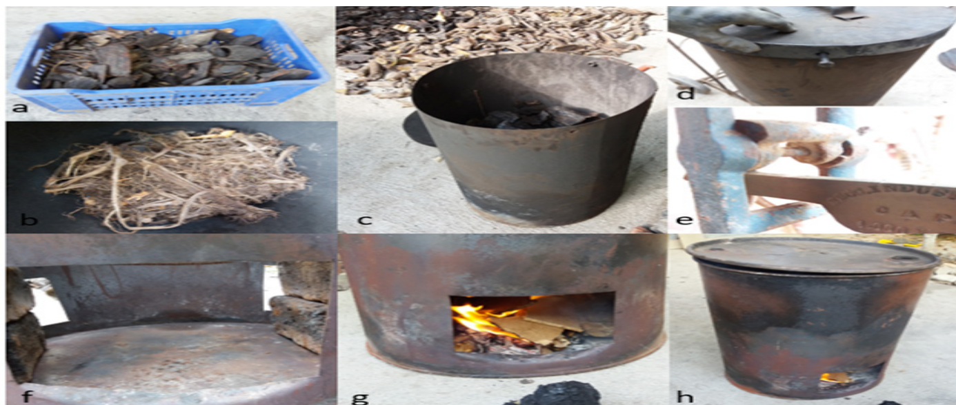
Figura 6. Producción de biochar de raquis de banano y cascara de cacao. a) Cascara de cacao. b) Raquis de banano. c). Almacenamiento de la materia prima. d) Sellado del tambor interno. e) Pesado del tambor interno. f) Cámara de combustión. g) Ignición de la leña. h) sellado del tambor externo.
